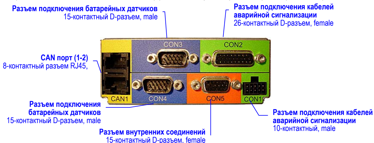
Рисунок 4. Разъемы на задней панели контроллера Smartpack .
