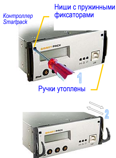
Рисунок 9. Фиксирующий механизм контроллера Smartpack .
